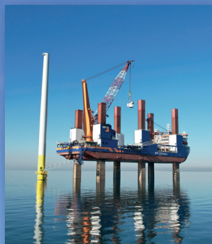
MPI Resolution - Jack-up Vessel impiegato per l'infissione dei monopali e l'installazione delle turbine di Beleolico
